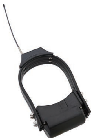
■図1. サル用GPS首輪発信器 GLT-02
