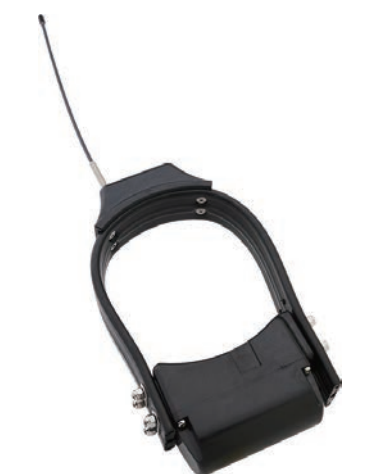
■図1. サル用GPS首輪発信器 GLT-02
