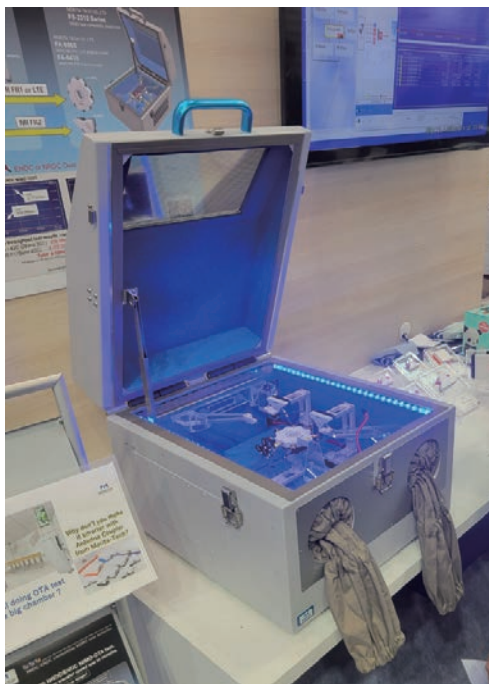
■図2. FS-2310 MIMO OTA試験ユニット
