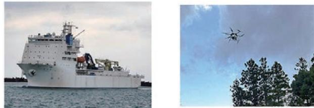
■ 図4. 船舶基地局及び有線給電ドローン基地局
