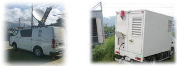
■ 図3. 車載型基地局及び移動電源車
