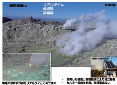
図11. 自立電源・高精細映像による火山監視
