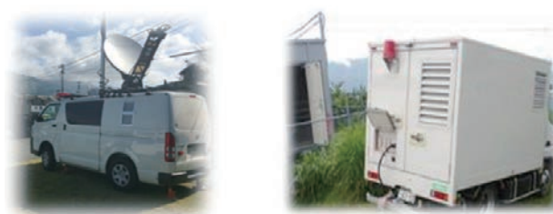
■図3. 車載型基地局及び移動電源車
