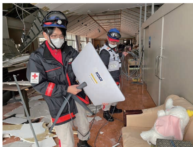
■図2. 被災地で利用される衛星通信専用端末
