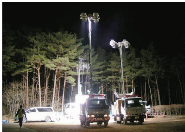
■図1. 静止衛星通信を携帯電話基地局のバックホール回線
