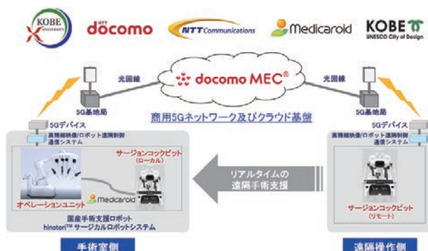
■ 図4. 5G遠隔ロボット手術支援ソリューションのシステム構成イメージ
