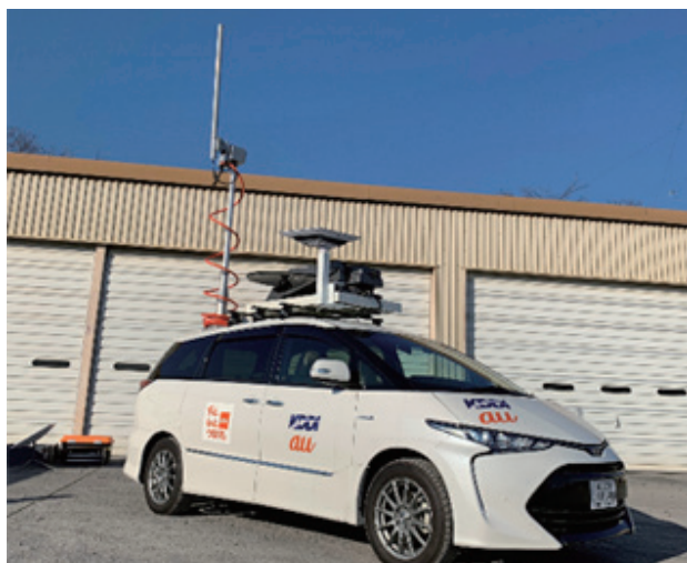
■図4. Starlinkを搭載した車載型基地局
