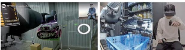
■ 図9. テレイグジシステムによるニチレイロジグループ倉庫での遠隔ロボット実証、ファミリーマートでの飲料品出し実証
