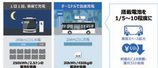
■図9. 急速充電式バスへの適用例
