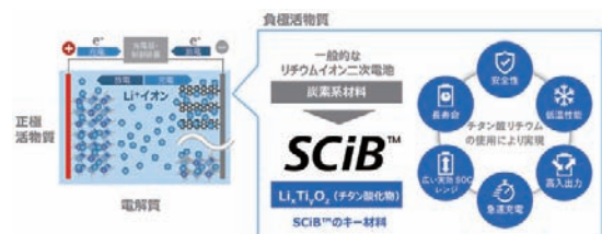
■ 図3. リチウムイオン電池の基本構成とSCiB™の特長
