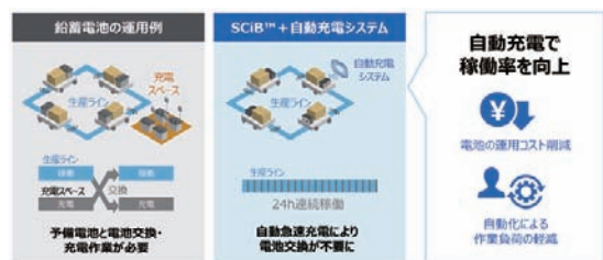
■図10. 無人搬送車 (AGV) への適用例
