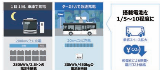
■図9. 急速充電式バスへの適用例
