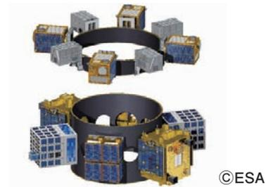
■ 図7. 小型衛星搭載方法：ライドシェア方式（多種多様な衛星が所狭しと搭載）
