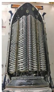
■ 図8. Starlink衛星の60機同時打ち上げの搭載方式（弁当箱のように積みあがっている）(Elon Musk氏 2019年 Tweetより)
