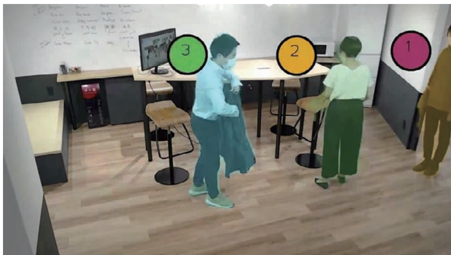
■ 図1. 同一人物トラッキングAI。事前登録なしでIDが付与される。姿勢・骨格なども判断するため、ジャケットの着脱をしても同じIDが割り当てられたままである
