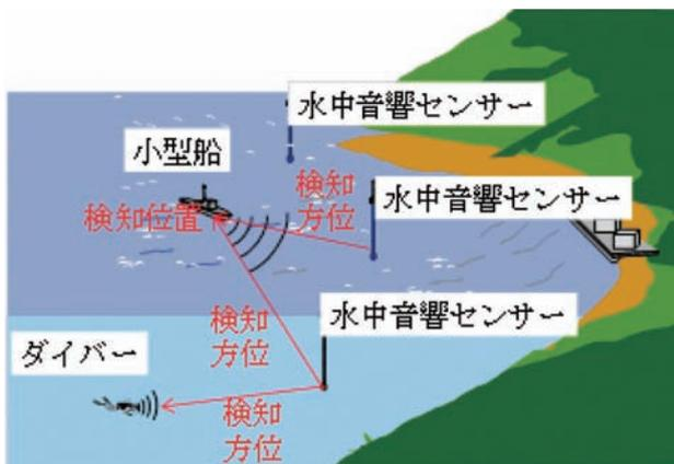
■ 図5. 水中音響センサーによる目標検知
