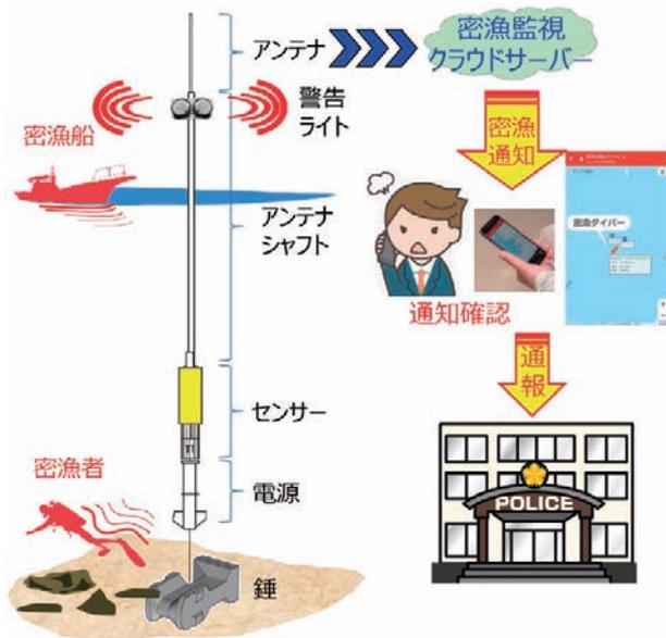
■ 図4. ブイ方式水中音響センサーの例
