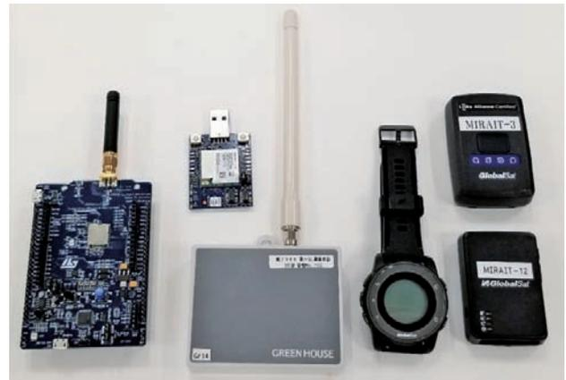
■ 写真2. LoRaWAN電波特性調査に利用したエンドノード機材(一部)
