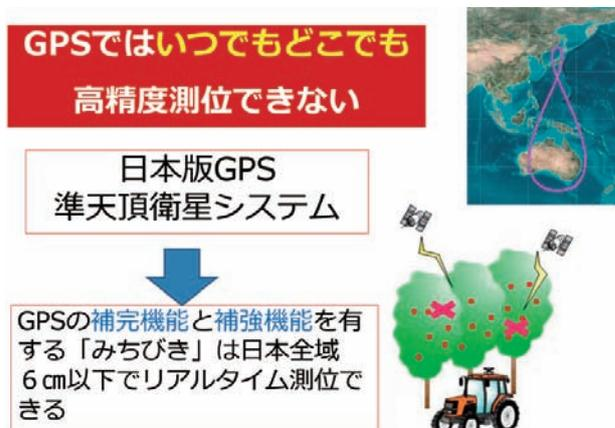
■ 図6. 準天頂衛星システム「みちびき」
