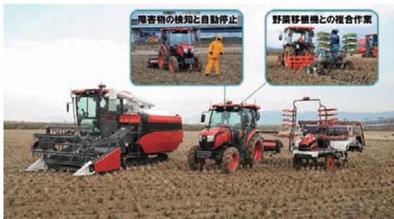
■ 図7. 自動トラクタ・田植機・コンバイン
