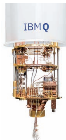
■ 図2. IBMの量子コンピュータ外観 (希釈冷凍機の下半分を外したところ)
