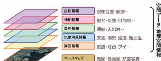
■図3. J-Marine GISのレイヤ構造
