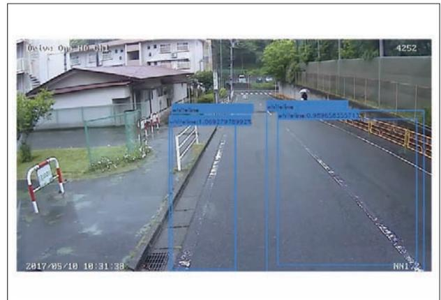
■ 図8. ゴミ収集車のカメラによる白線かすれ自動検出
