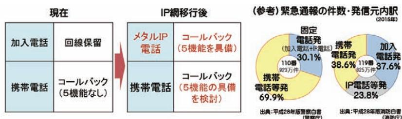
■ 図5. IP網移行に対応した緊急通報の機能
