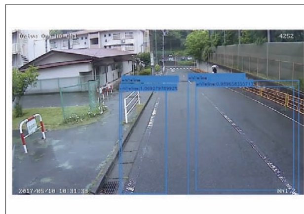
■ 図8. ゴミ収集車のカメラによる白線かすれ自動検出
