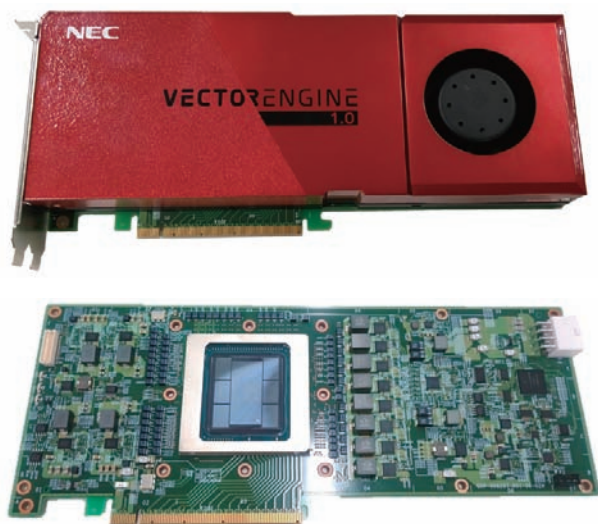
■図1. Vector Engineカード (上: カード外観、下: 内部ボード)
