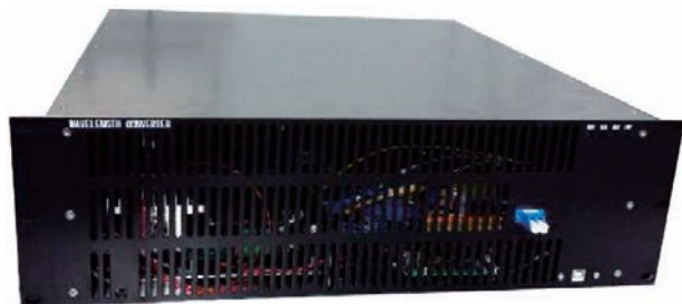
■図2. 高効率パラメトリック過程による全光一括波長変換器の試作機概観。標準ラック準拠
