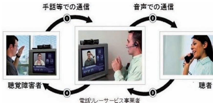
■ 図4. 電話リレーサービスの仕組み
