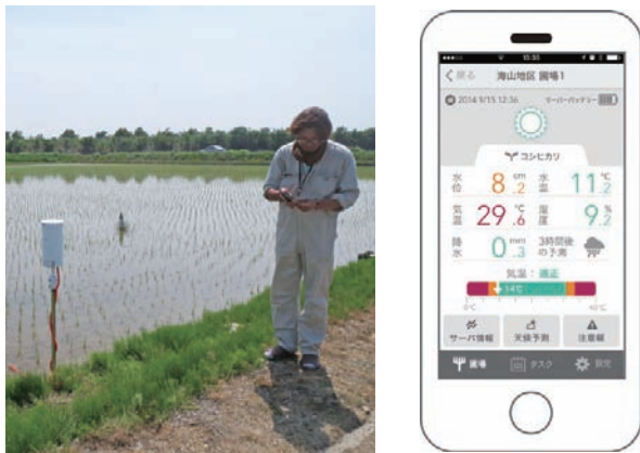
■写真3. 水田センサを活用する農業者及びスマートフォンでのデータ取得画面（2016年5月）
