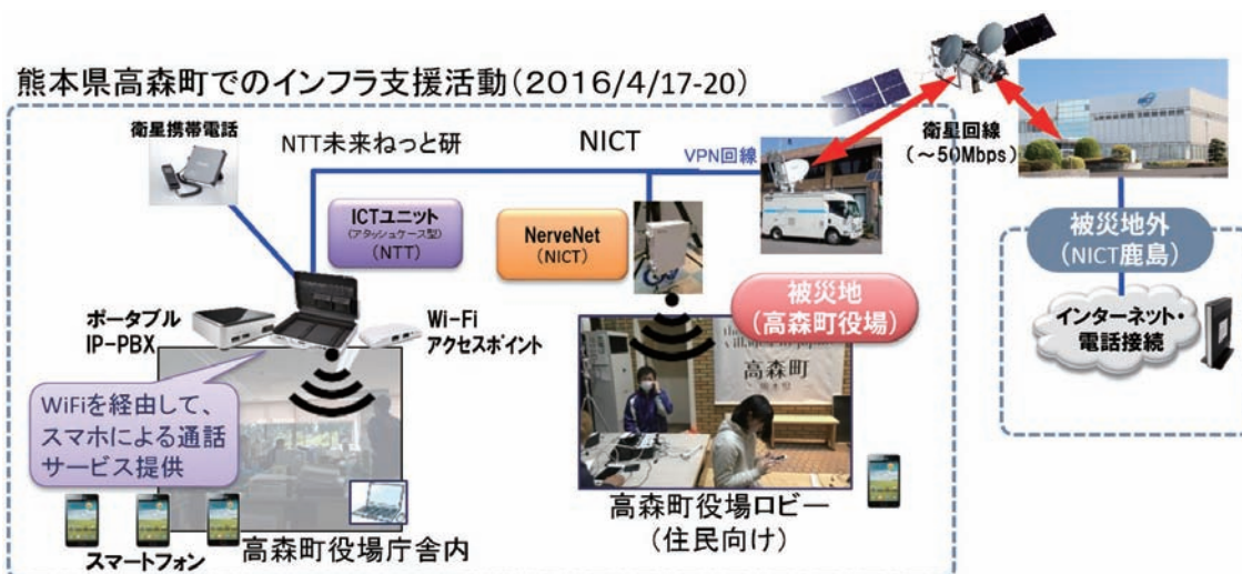
■図7. 高森町におけるネットワーク支援における機器構成図
