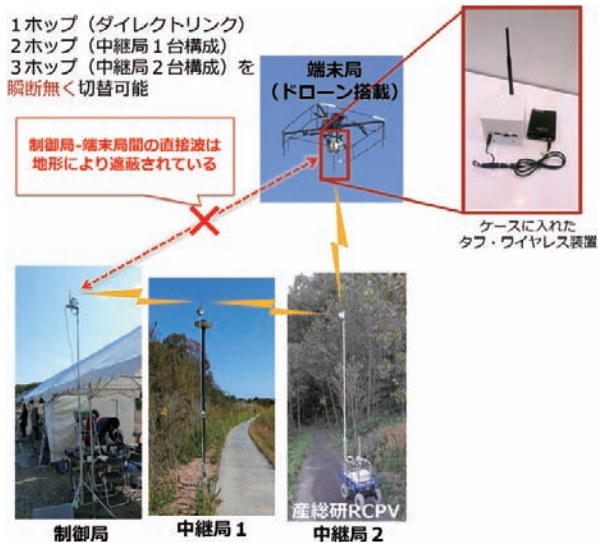
■ 図2. 見通し外中継制御のフィールド実証実験 (2016年11月@東北大学青葉山キャンパス)
