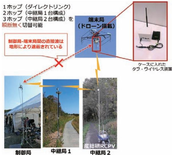
■図2. 見通し外中継制御のフィールド実証実験
