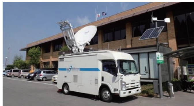
■ 写真1. 熊本震災時に高森町に設置したWINDS用衛星地球局
