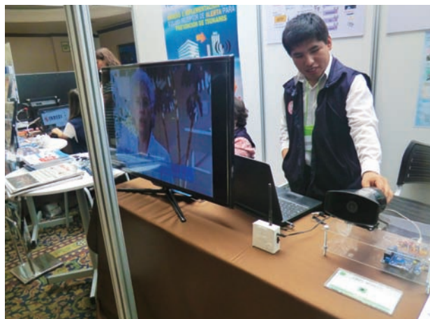
■写真4. ペルーにおけるEWBS受信機を内蔵した防災スピーカーの試作機
