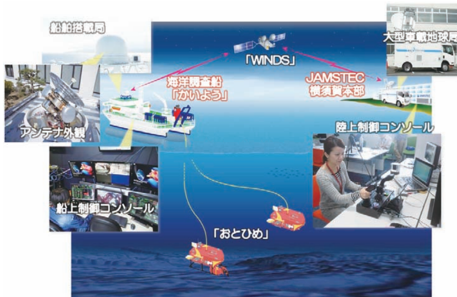
■ 図3. 深海探査機「おとひめ」のテレオペレーション実験の構成
