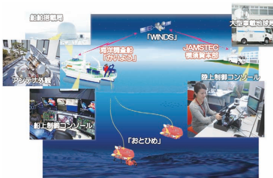
■図3. 深海探査機「おとひめ」のテレオペレーション実験の構成
