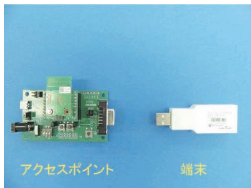
開発した無線機の外観 (左：アクセスポイント、右：端末)
