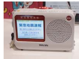
(3)防災・安心情報 地震や津波が発生すると、受信機の電源が自動的に入り、音声やテキストで警報を出します。
