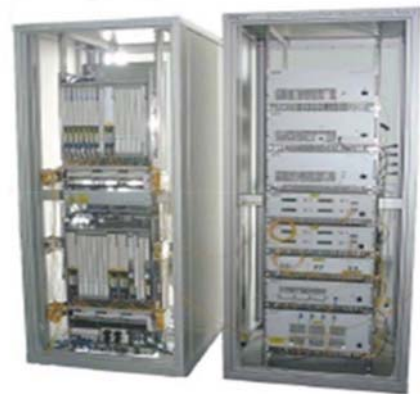
図3. 光パケット・光パス統合ネットワークテストベッド設備
