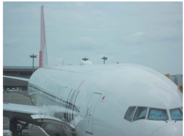
アンテナはドーム型のカバーに納められている
