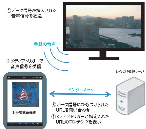
図3. メディアトリガーの音声同期を使ったデータ受信の仕組み
