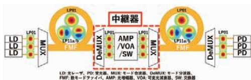
■ 図2. FMFを用いた長距離伝送システムの構成例
