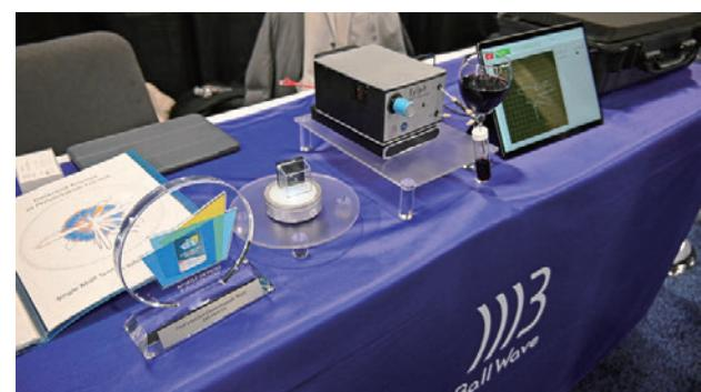
■図5. 東北大学発のベンチャー企業ボールウェーブは、同大が発見したSAWの伝播原理を活用した超小型ガスクロマトグラフィ装置を開発した。
