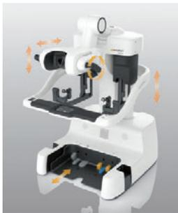
■ 図8. 執刀医側操作部の調整機構の例
