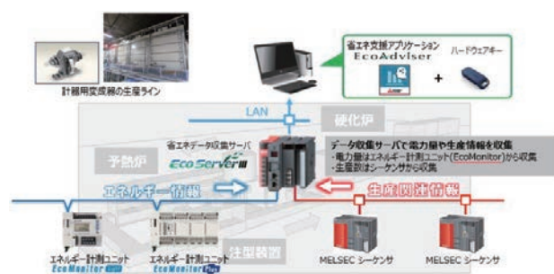
■図11. 変成器生産ライン エネルギー管理システム
