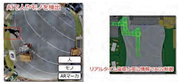
■図4. 映像測位とAGV制御への活用例
