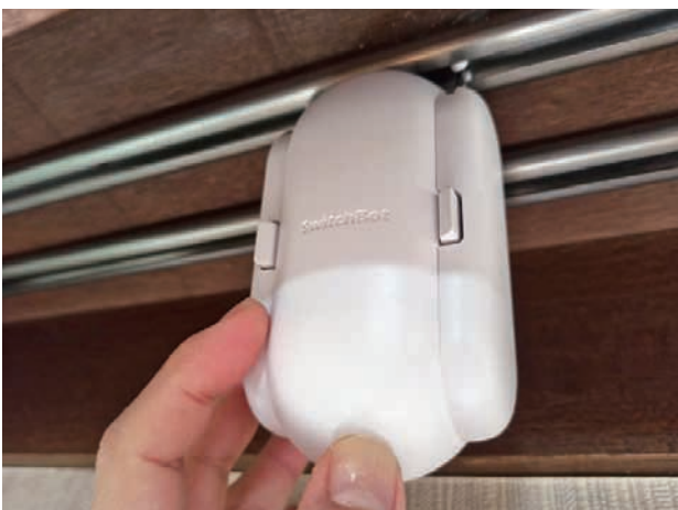
■図2. 上部のローラーでカーテンレールを移動する
