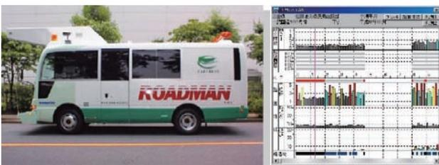
■ 図5. 路面性状計測車（写真）と解析結果
