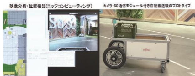
■図6. エッジコンピューティングを活用した自動搬送機の共同検証
