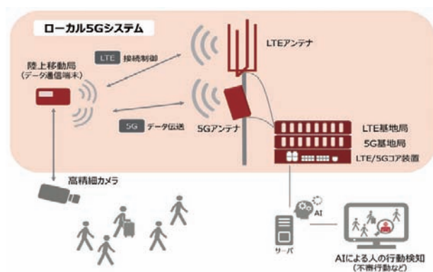
■図1. ローカル5Gを活用したセキュリティシステム構成
