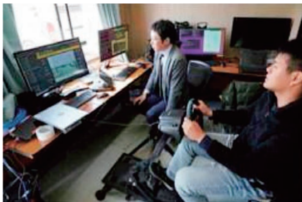
■図7. 放置車両の遠隔操作（遠隔車両操作センター）
