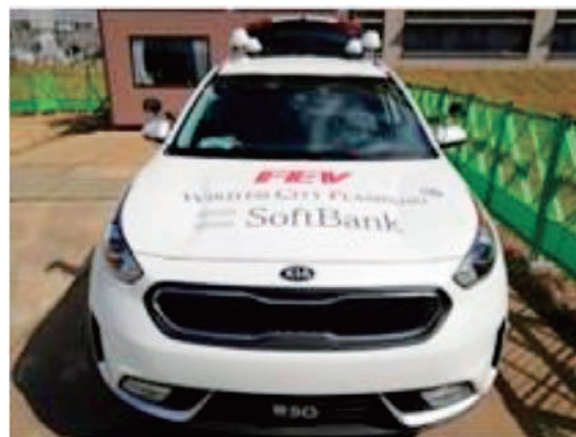
■図5. 5G無線端末を載せた遠隔運転車両
