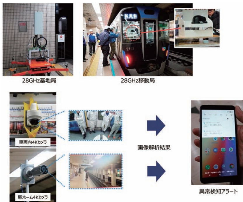
■ 図14. 地下鉄安全確保支援試験の様相
