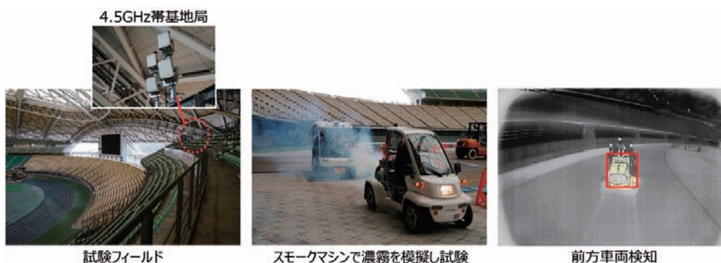
■図16. 濃霧の中での運転補助試験の様相
