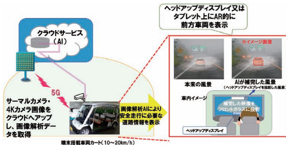
■図15. 5Gを活用した濃霧の中での運転補助に関する実証試験
