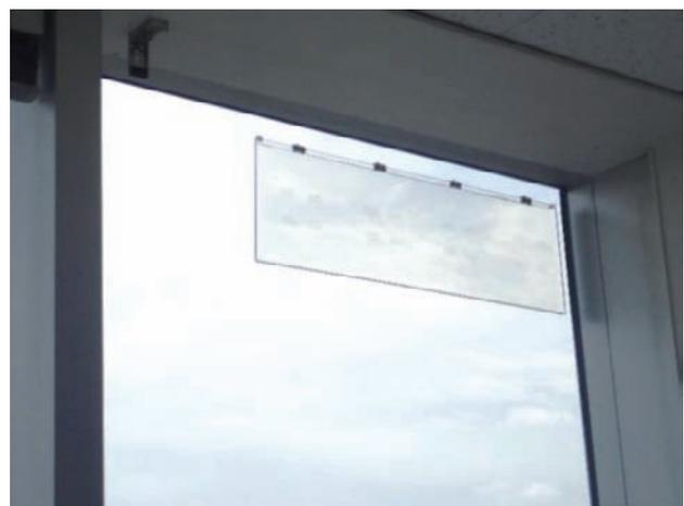
■図2. 建物用ガラスアンテナ (※ケーブル接続なしの状態)
