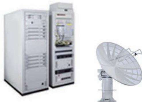
■図4. C帯固体化マルチパラメータ気象レーダ
