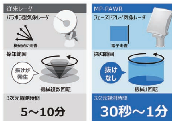
■ 図7. 従来レーダとMP-PAWRのアンテナ走査方式の比較
