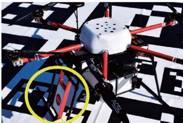
携帯電話を機体に搭載。当該携帯電話のLTE回線及びアプリを使用することにより、機体の位置情報をサーバーに送信。
