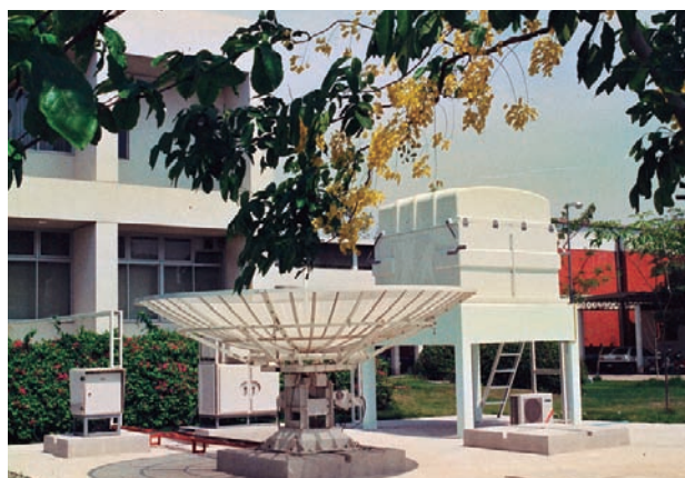
■図5. KMITL敷地内に設置された環境計測装置 右はLIDAR、左はウインド・プロファイラ・レーダー
